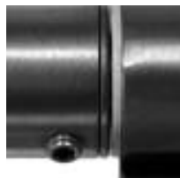
Fixierschraube hat nicht in die Rasterung eingegriffen
